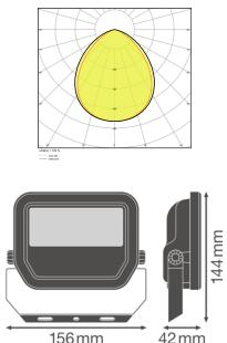
**Caractéristiques Ledvance Projecteur LED GEN 3 Blanc 20W 2400lm 100D - 865 | IP65 - Symétrique - Remplacement 50W**
