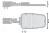
**Caractéristiques Ledvance Projecteur LED Area Moyen Gris 65W 8450lm 160x58D - 730 | IP66 - Symétrique**
