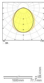
**Caractéristiques Ledvance LED Rail de fixation suspendu Trusys Flex Opale 35W 5600lm 90D - 840 Blanc Froid | Dali Dimmable**
